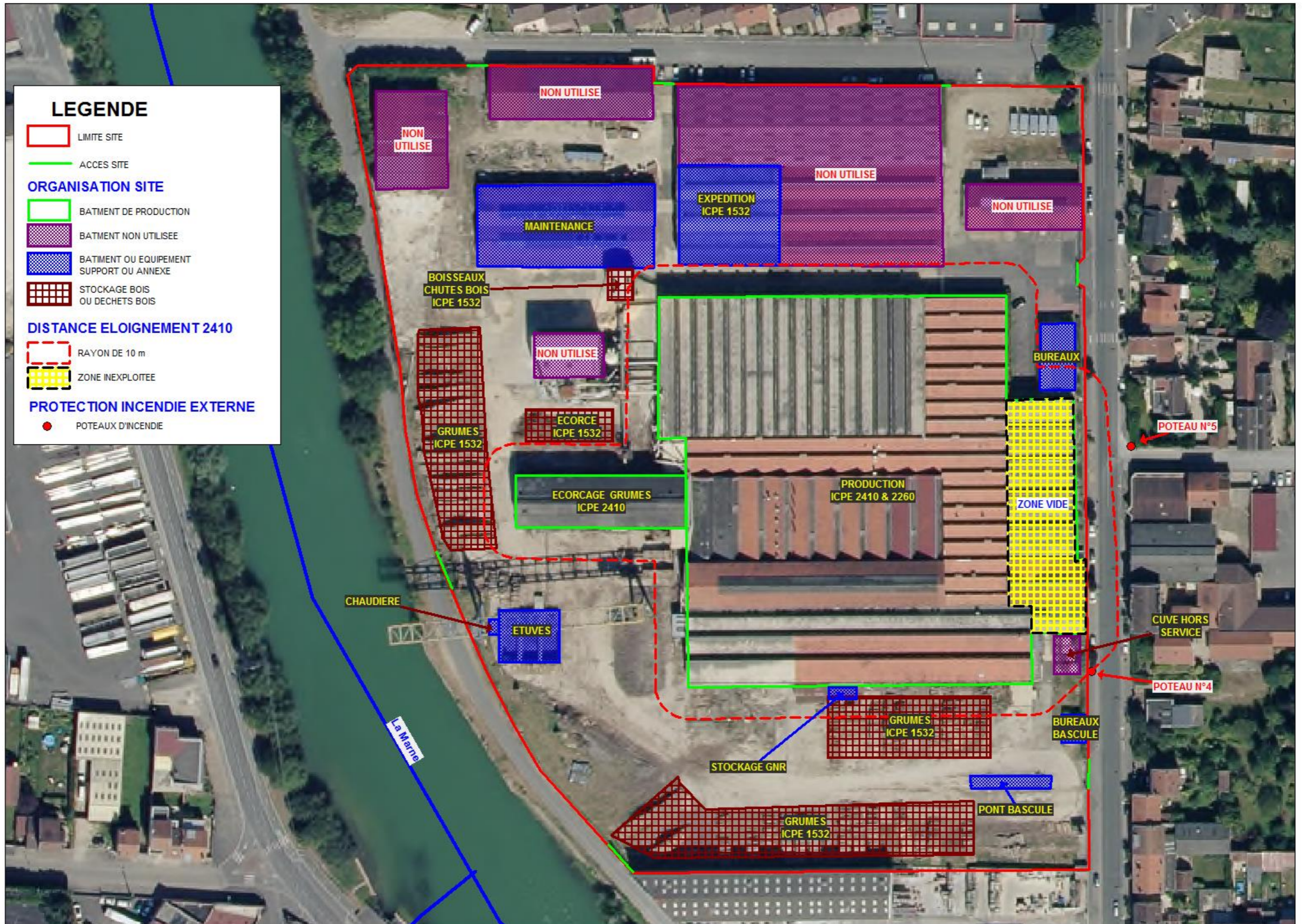
PLAN 1 : DISTANCES DE 10 m D'ELOIGNEMENT DES BATIMENTS DE TRAVAIL DU BOIS CLASSES EN 2410.
